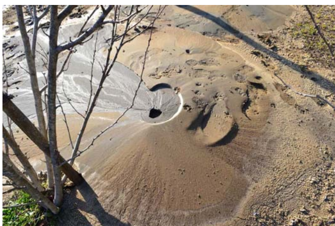
習志野市袖ヶ浦 2 丁目袖ヶ浦保育所脇の噴砂口 ここでは暗灰色の泥質砂が噴出したの後に茶褐色の砂 が噴出した。 2011.3.14
